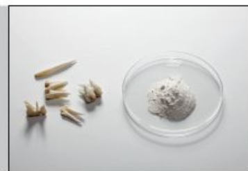
使用 FRITSCH PULVERISETTE 0 研磨的牙齿前后对比图
