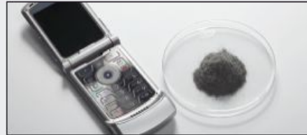
移动电话按键: 研磨后冻结条件下的脆化效果
