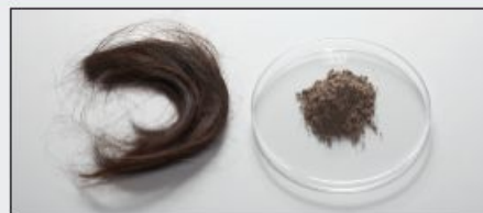
使用 FRITSCH PULVERISETTE 23 进行头发样品研磨的之前和之后
