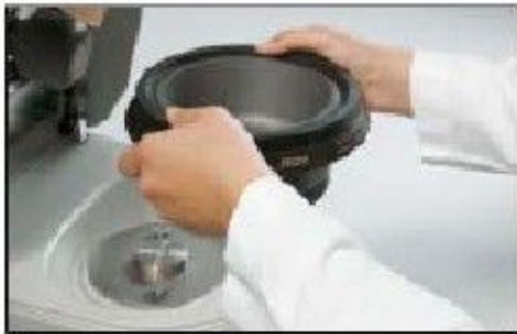
操作简便，极其安全：快速紧固卡销，可夹紧研钵
